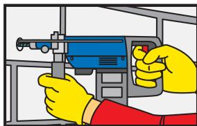
Izbušiti rupu električnom bušilicom u potrebnom prečniku i dubini. Prečnik izbušene rupe mora biti u skladu sa dimenzijama ankera.
