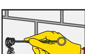
Izbušena rupa mora biti detaljno očišćena specijalnom čeličnom četkom (iščekati najmanje 2 puta). Prečnik četke mora biti veći od prečnika izbušene rupe.
