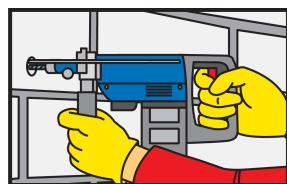
1. Bušenje rupe električnom bušilicom u potrebnom prečniku i dubini. Prečnik probušene rupe mora biti u skladu sa dimenzijama ankera.
