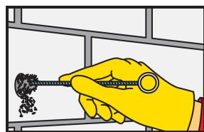
3. Izbušena rupa mora se temeljno očistiti pomoću specijalne čelične četke (očetkati najmanje 2 puta). Prečnik čelične četke mora biti veći od prečnika izbušene rupe.
