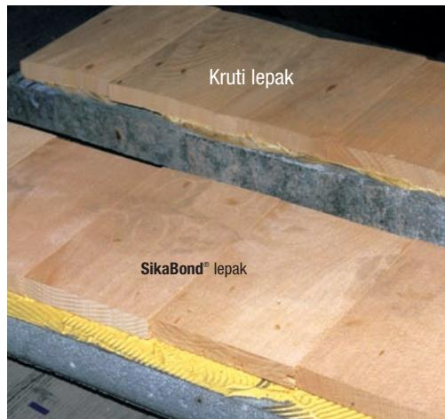
Testiranje pod ekstremnim uslovima: 21 mm debljina daske od bukve, 22% sadržaj vlage
