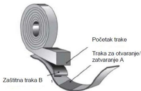
3) Lepljivu stranu trake blago pritisnite na čist prozorski okvir. Početak i kraj trake moraju se spojiti tako da se preklapaju u ukupnoj dužini od 10-20 mm. Traka mora biti 6 mm manja od debljine prozorskog okvira. Traka se mora postaviti na udaljenosti od 1 mm od spoljašnje strane okvira i 5mm od unutrašnje strane okvira.
