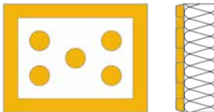
Slika 3. Tačkasto i obodno nanošenje lepka
