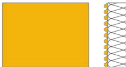
Slika 2. Nanošenje lepka po celoj poledini ploče
