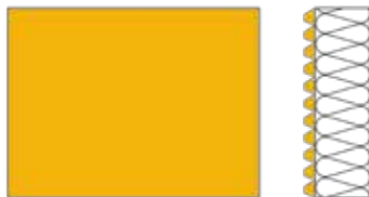
Slika 9. Nanošenje lepka po celoj poledini
