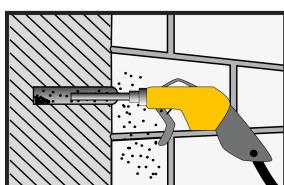
2. Izbušena rupa mora se očistiti komprimovanim vazduhom, koji ne sadrži ulje, pod pritiskom oko 6 bara. Početi od dna ka vrhu i očistiti najmanje dva puta, sve dok u povratnom vazduhu nema prašine
