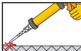
7. Pumpajte barem 2 puta dok se obe komponente ne istisnu u jednoj uniformnoj boji. Nemojte koristiti ovaj materijal. Otpustite pritisak i krpom očistite vrh statičkog mešača.
