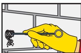
3. Izbušena rupa mora se temeljno očistiti pomoću specijalne čelične četke (očetkati najmanje 2 puta). Prečnik čelične četke mora biti veći od prečnika izbušene rupe.
