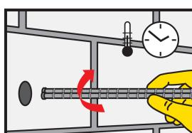
9. Kružnim pokretom ubacite anker u lepkom napunjenu rupu. Anker se mora postaviti u toku otvorenog vremena. Određena količina lepka mora izaći iz rupe.
