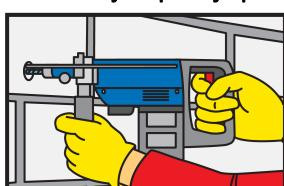
1. Bušenje rupe električnom bušilicom u potrebnom prečniku i dubini. Prečnik probušene rupe mora biti u skladu sa dimenzijama ankera.
